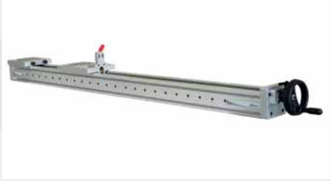
Bi-Rail Linearmodul MV90 mit Trapezspindel und Sonderlösung für Handblockage der Bronzemutter Bi-Rail Linear Module with trapezoidal screw and special blocking system on bronze nut
