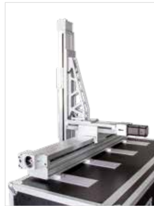
Système XYZ transportable pour l'usinage sur site
