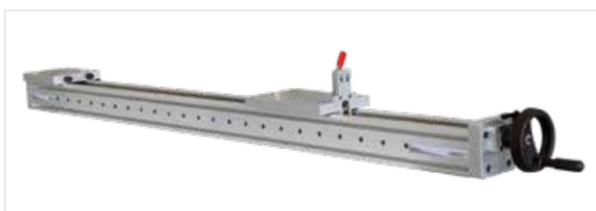
Modulo Lineare Bi-Rail MVP090 con vite trapezia e bloccaggio manuale su chiocciola
