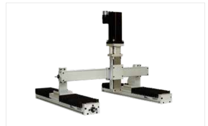
Sistema XYZ di Unità Lineari CVP040 / CVP060 per incollaggio
